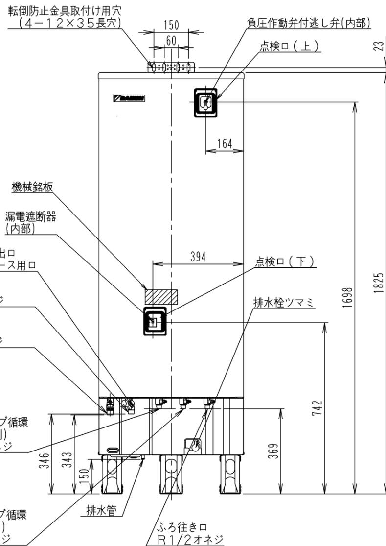
●アンカーボルトおよび配管位置図
